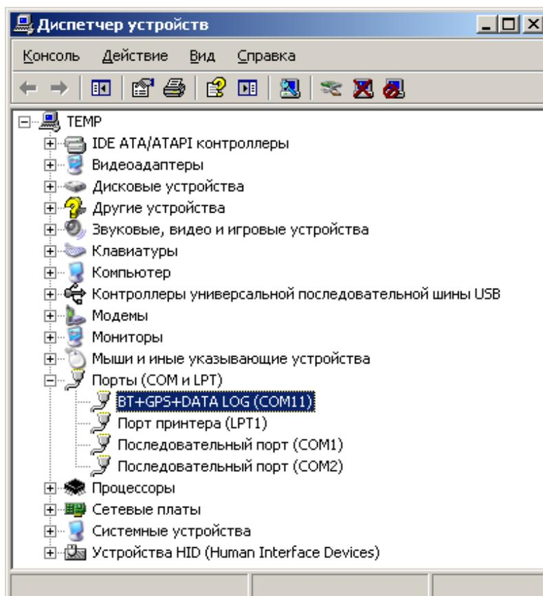
После установки драйвера для ГдеМои S5 вы можете выполнять настройки датоloggера и выгружать данные в файл с помощью прилагаемой утилиты.
