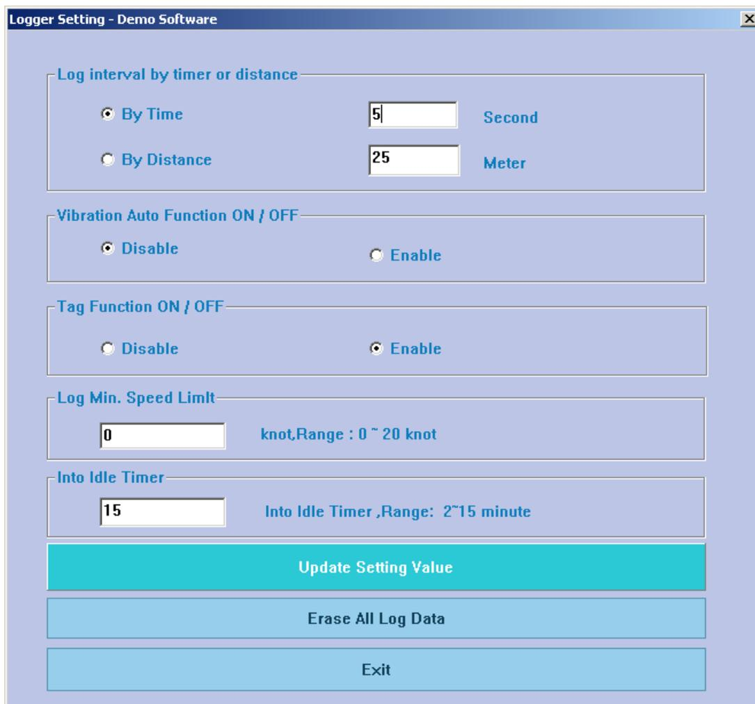
Запись координат по времени возможна при указании значений этого параметра («By Time») в пределах от 1 до 3600 секунд, по пройденному расстоянию («By Distance») в пределах от 25 метров до 3000 м.
