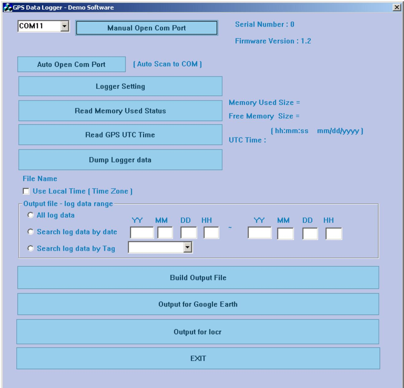
Подключиться к нужному COM порту можно и без указания его номера, для этого надо нажать кнопку «AutoOpenComPort».
