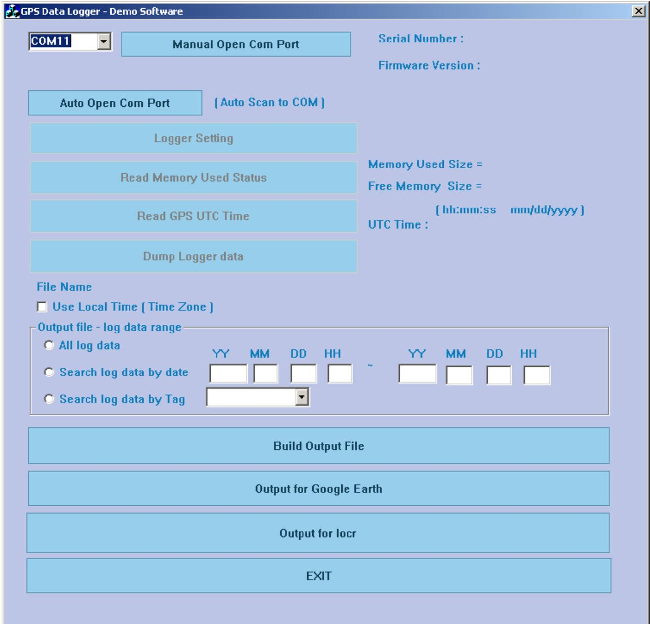
Нажмите кнопку «Manual Open Com Port», если программа сможет получить доступ к COM порту, то неактивные изначально кнопки станут доступны и отобразится серийный номер устройства и версия прошивки.
